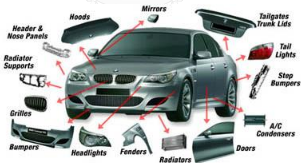
รูปที่ 1.1 ตัวอย่างชิ้นงานที่ผลิตจากกระบวนการฉีดขึ้นรูปพลาสติก
