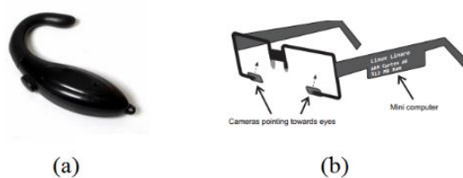
รูปที่ 1 ระบบที่ติดตั้งกับผู้ขับขี่ a) แนปแซปเปอร์, b) แว่นตาอัจฉริยะ
