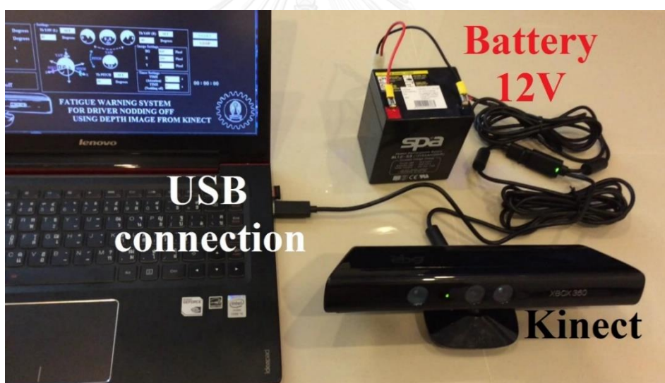
รูปที่ 37 อุปกรณ์ที่ใช้สำหรับระบบเตือนภัยจากความเมื่อยล้า
