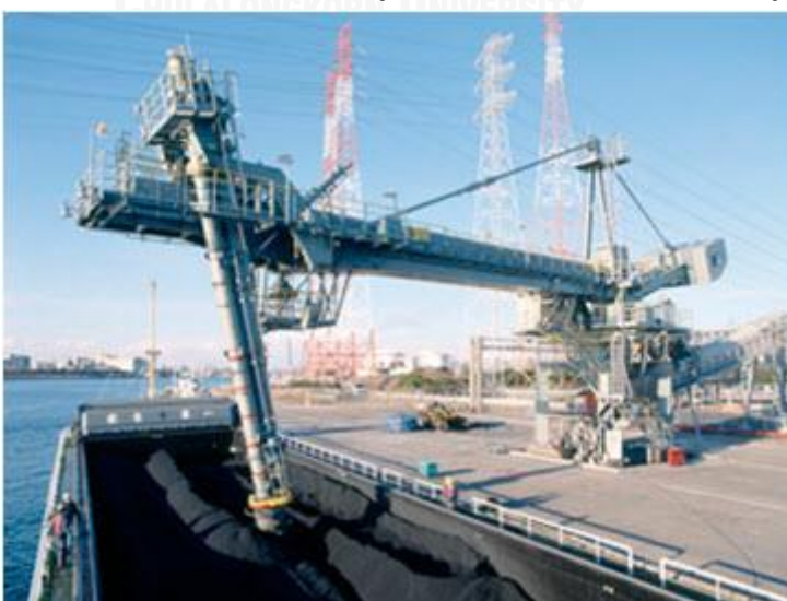
รูปที่ 3.11 ตัวอย่างอุปกรณ์ขนถ่ายจากเรือบรรทุกถ่านหินแบบสกรูดูดถ่านหิน
