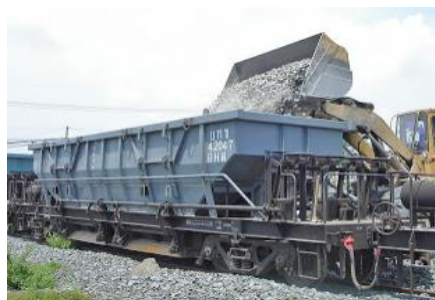
รูปที่ 3.7 รถโบกี้เทซ่าง (Bogie Hopper Wagon)
