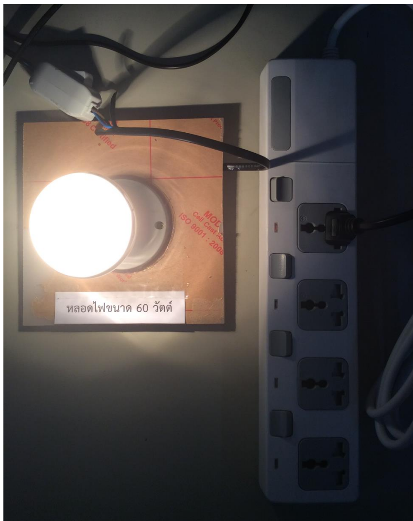
รูปที่ 39 หลอดไฟสว่างหลังจาก on Switch บนเว็บแอปพลิเคชัน
