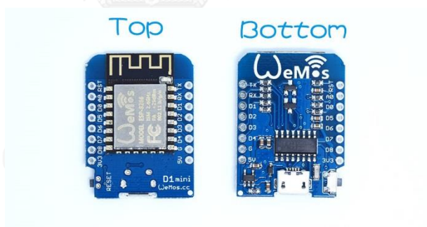
รูปที่ 13 บอร์ด WeMos D1 mini (ESP8266-12F) [16]
