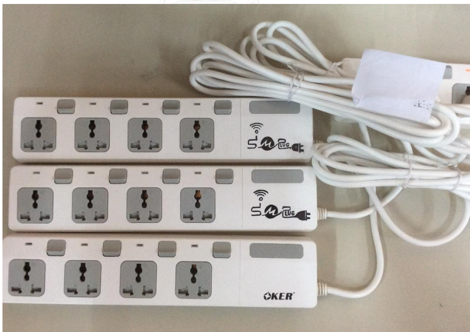
รูปที่ 33 การเชื่อมต่อปลั๊กอัจฉริยะ 3 ตัว เพื่อเป็นโหลด
