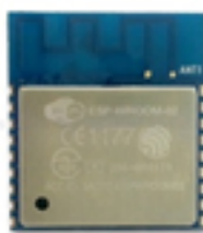
รูปที่ 12 บอร์ด ESP-WROOM02 (ESP8266-EX) [14]
