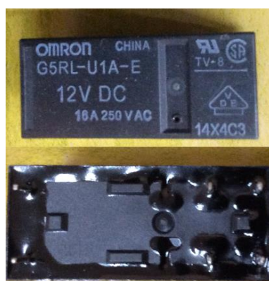
รูปที่ 18 แลตซ์ริงรีเลย์ (Latching Relay)
