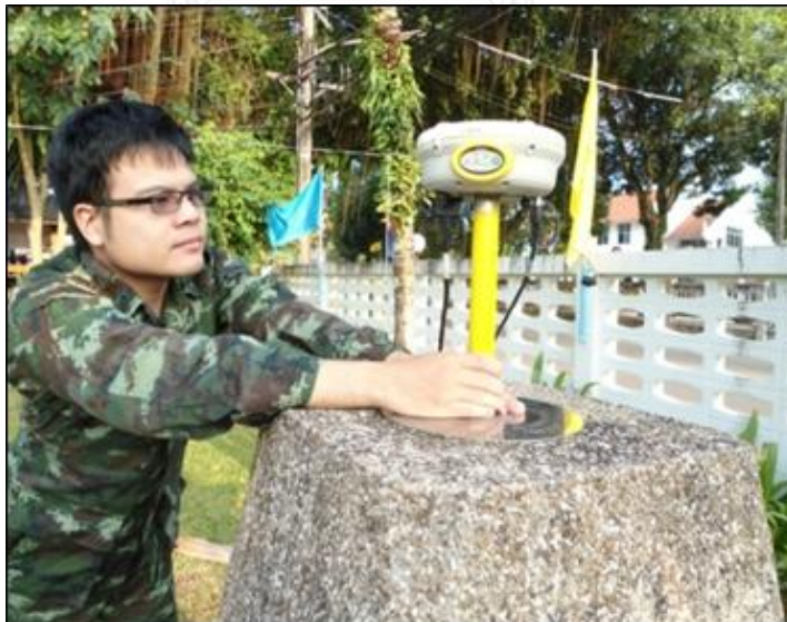
รูปที่ 12 อุปกรณ์เครื่องรับสัญญาณดาวเทียม GPS รุ่น Trimble 5800
