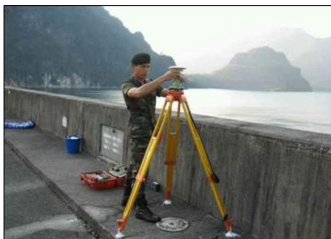
รูปที่ 10 อุปกรณ์เครื่องรับสัญญาณดาวเทียม GPS รุ่น Leica
