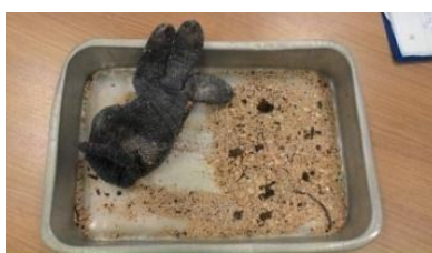
รูปที่ 28 แสดงตะกรันที่ปนมากับไอน้ำบริสุทธิ์ที่ผลิตจากระบบไอน้ำบริสุทธิ์ส่วนกลาง
