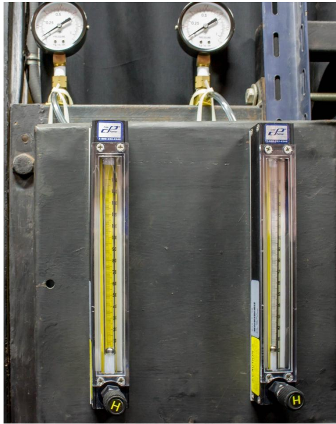
รูปที่ 4.19 Rotameter flow meter สำหรับเจ็ดควบคุม
