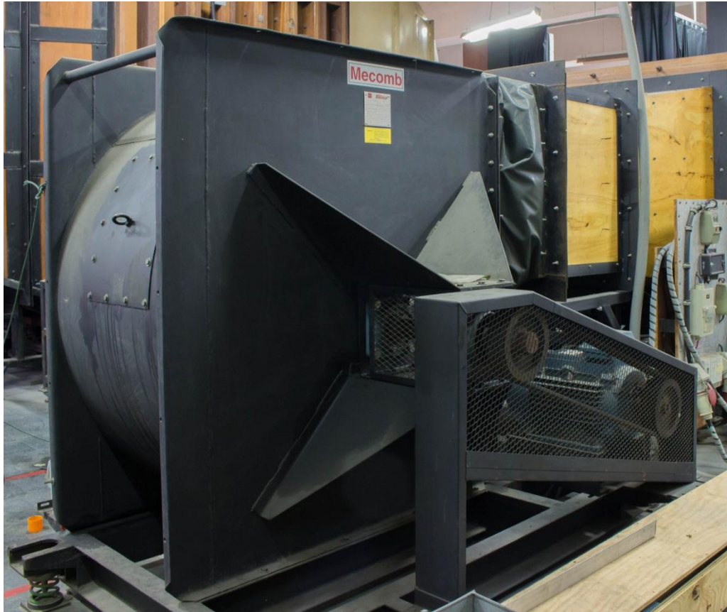
รูปที่ 4.6 Blower สำหรับอุโมงค์ลมเพื่อสร้างกระแสลมขวาง
