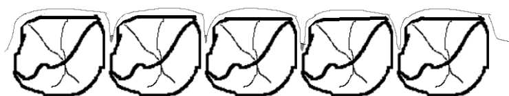
ภาพที่ 4.35 ภาพจำลองภาพตัดขวางของล้อยเจียร์ไนหลังลับคมแบบปกติต่อจากการใช้เจียร์ไนอะลูมินา-ไทเทเนียมคาร์ไบด์ 45 ขึ้น
