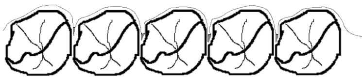
ภาพที่ 4.31 ภาพจำลองภาพตัดขวางของล่อเจียรไนหลังลับคมแบบปกติต่อจากการเจียรไนอะลูมินา-ไทเทเนียมคาร์ไบด์ 15 ซีซี
