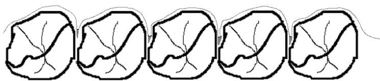
ภาพที่ 4.30 ภาพจำลองภาพตัดขวางของล่อเจียรไนหลังใช้เจียรไนอะลูมินา-ไทเทเนียมคาร์ไบด์ 15 ซีซี
