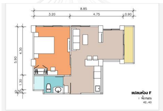
ภาพที่ 4.52 แปลน 1 ห้องนอน ขนาด 42.40 ตารางเมตร
