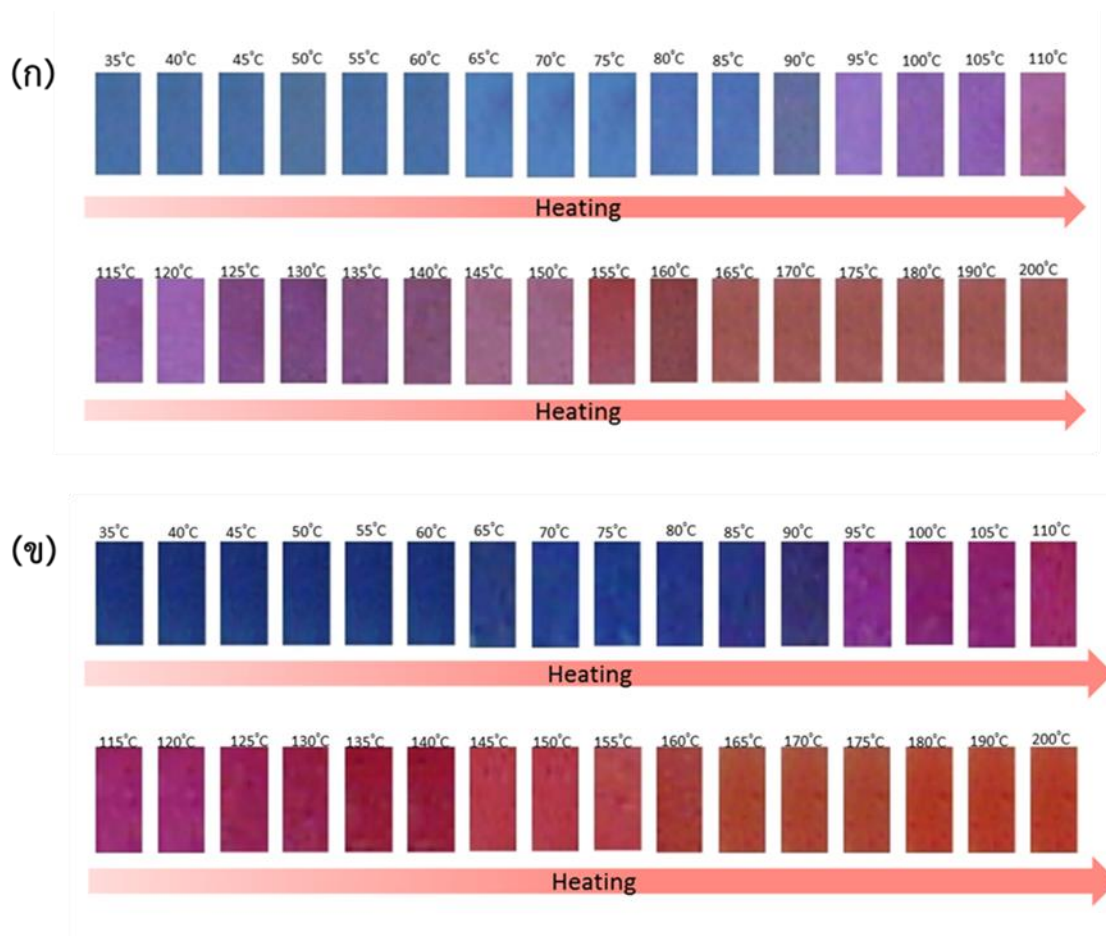
รูปที่ 4.10 ภาพถ่ายแสดงการเปลี่ยนสีของฟิล์ม (ก) poly(PCDA)/ZnO/ENR นาโนคอมพอสิต (2.93 phr) และ (ข) poly(PCDA)/ZnO/ENR นาโนคอมพอสิต (5.87phr) เมื่อได้รับความร้อนที่อุณหภูมิตั้งแต่ 35 ถึง 200 องศาเซลเซียส
