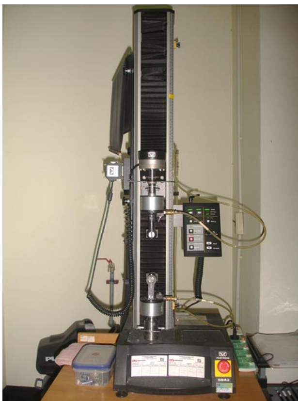
รูปที่ 3.3 เครื่อง Universal testing (NISTON-5843)
