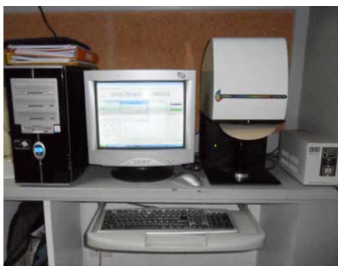
ภาพที่ 3-13 เครื่องวัดสมบัติเชิงแสงของแผ่นทดสอบ Technidyne color touch PC
