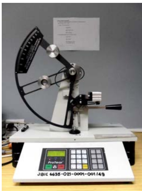
ภาพที่ 3-15 เครื่องวัดความต้านทานแรงฉีก (elmendorf tearing resistance tester)
