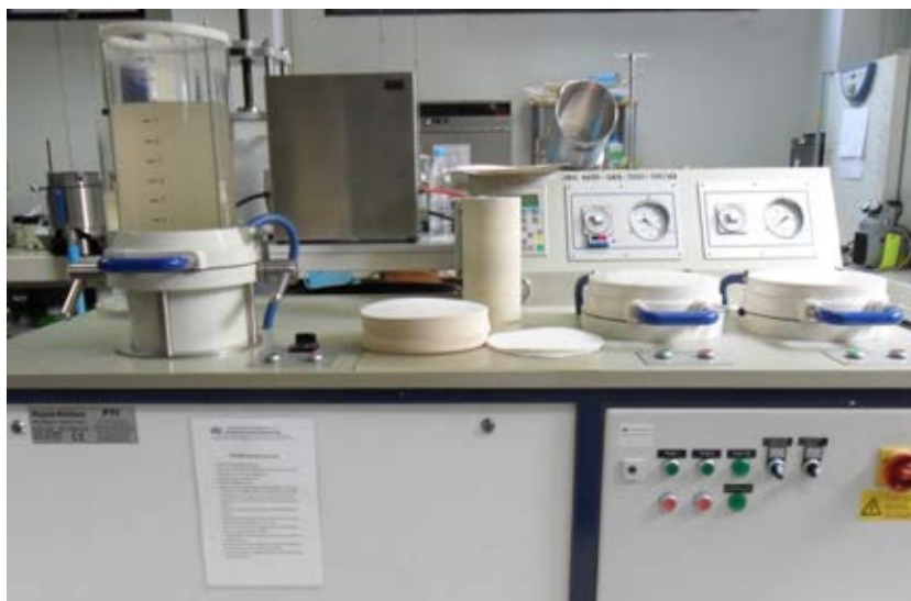
ภาพที่ 3-7 เครื่องขึ้นแผ่นทดสอบ (Rapid-Kothen sheet former)
