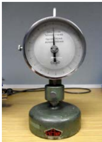
ภาพที่ 3-11 เครื่องวัดความหนา (thickness tester)
