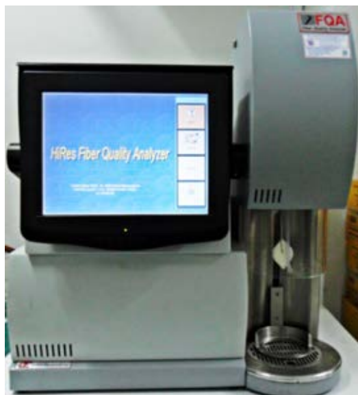
ภาพที่ 3-6 เครื่องวิเคราะห์เส้นใย (Fiber Quality Analyzer : FQA)
