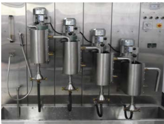
ภาพที่ 3-4 เครื่องคัดขนาดเส้นใย (Bauer-McNett classifier)
