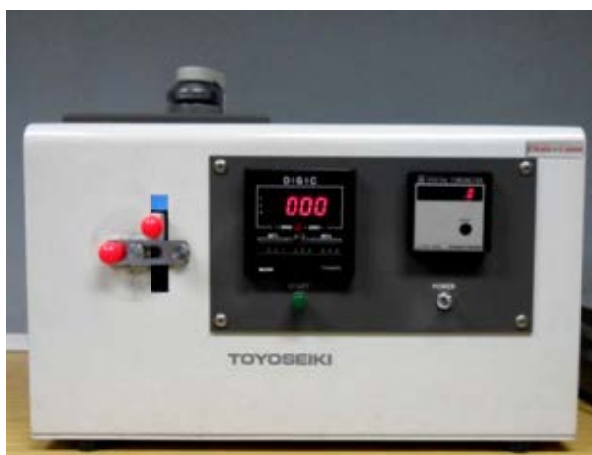
ภาพที่ 3-12 แสดงเครื่องวัดความเรียบของกระดาษ (smoothness tester)
