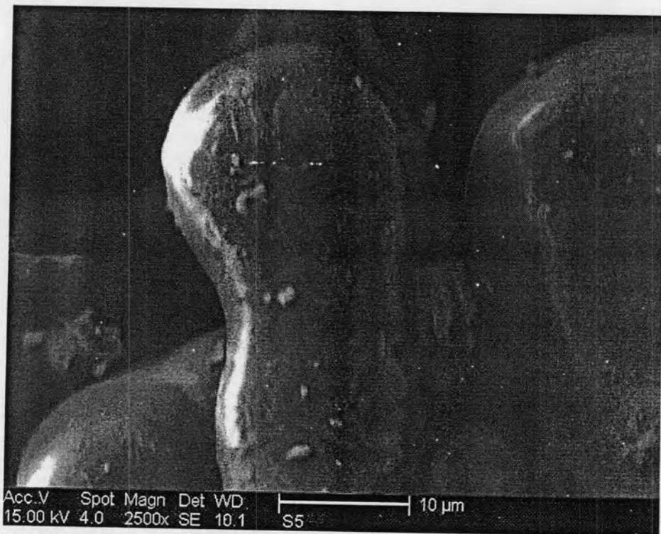
รูปที่ 4.7 ลักษณะโครงสร้างภายในปูนเม็ดที่กำลังขยาย 2500 เท่า ตรวจสอบด้วยเครื่อง SEM
