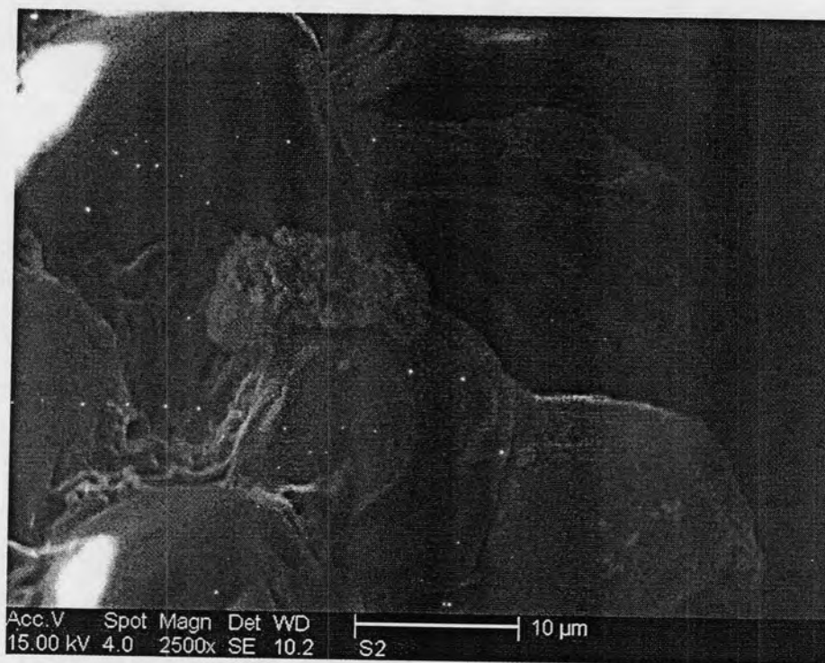
รูปที่ 4.8 ลักษณะโครงสร้างที่ผิวภายในปูนเม็ด ที่มีแคลเซียมออกไซด์ ตรวจสอบด้วยเครื่อง SEM
