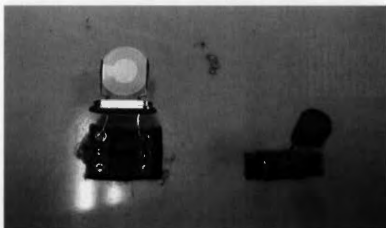
รูปที่ 3.6 QCM และเซนเซอร์วัดอุณหภูมิที่ใช้ในงานวิจัย
