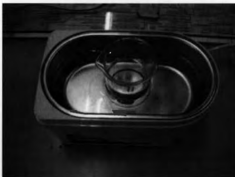
รูปที่ 3.10 การโซนิเคต QCM ด้วยโซนิเคเตอร์
