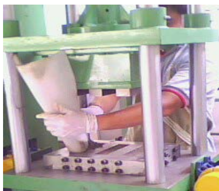
รูปที่ 4.5 เครื่องอัดขึ้นรูปก้อนมอร์ตาร์
