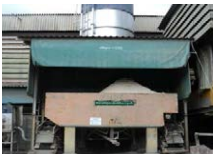
รูปที่ 5.8 การติดตั้งผ้าใบให้กับ sand bin
