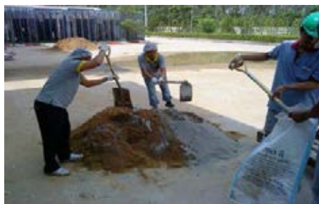
รูปที่ 5.10 การผสมทราย และเศษกระเบื้องบด นอกสายการผลิต
