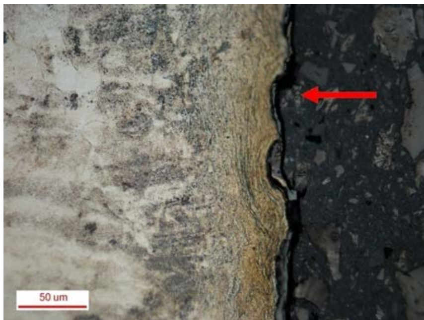
ภาพที่ ข.3 บริเวณที่เกิดการสูญเสียของวงแหวน เมื่อทดสอบการสึกหรอที่แรงกด 320 นิวตัน
