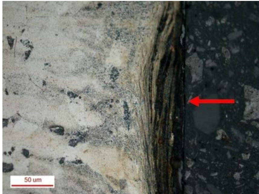
ภาพที่ ข.1 บริเวณที่ไม่เกิดชั้นสีเทา เมื่อทดสอบการสึกหรอที่แรงกด 320 นิวตัน
