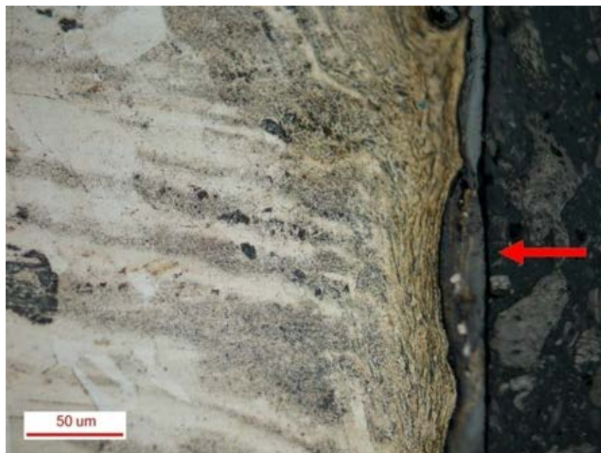
ภาพที่ ข.2 บริเวณที่เกิดชั้นสีเทา เมื่อทดสอบการสึกหรอที่แรงกด 320 นิวตัน
