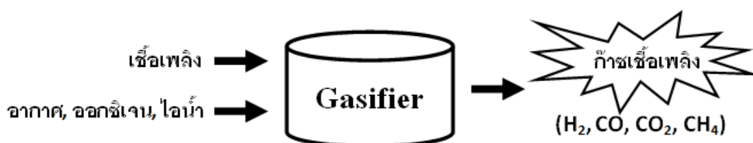
รูปที่ 2.7 กระบวนการผลิตแก๊สเชื้อเพลิงอย่างง่าย
