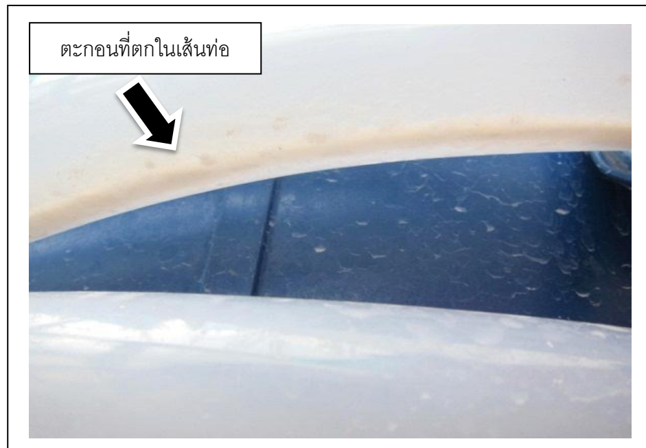
ภาพที่ 4-8 การตกตะกอนภายในไฮดรอลิคฟลิวคูลเตอร์ซึ่งเป็นสายยางพีวีซีใส ที่อัตราการไหล 100 ลิตรต่อชั่วโมง หรือความเร็วเกรเดียนท์ 83.35 ต่อวินาที
