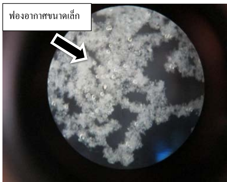
ภาพที่ 4-39 ฟล็อกชนิดพิเศษ ซึ่งมีฟองอากาศขนาดเล็กแทรกอยู่ภายใน (Aerated floc)
