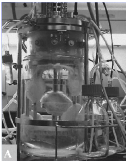
รูปที่ 2.12 การเจริญแบบแขวนลอยของ R. oryzae ในเครื่องปฏิกรณ์ชีวภาพชนิดถังกวน ที่มา : Tay และ Yang, 2002
