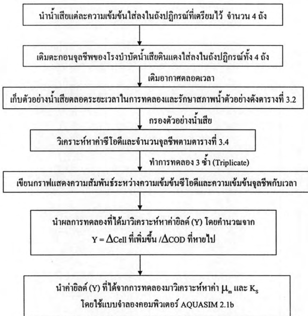
รูปที่ 3.6 แผนภาพขั้นตอนแสดงการทดลองหาค่าสัมประสิทธิ์การเจริญเติบโตและค่าตัวแปรทางจลนพลศาสตร์ของจุลชีพที่ความเข้มข้นต่ำและสูง
