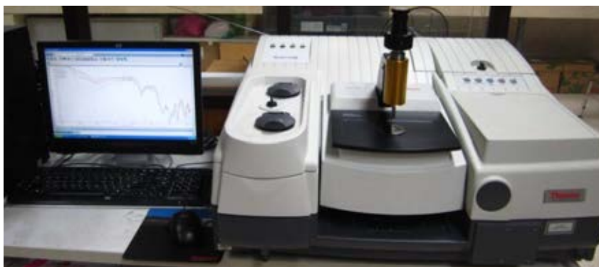
รูปที่ 3.1 เครื่องฟูเรียร์ทรานสฟอร์มอินฟราเรดสเปกโทรโฟโตมิเตอร์ (FTIR)
