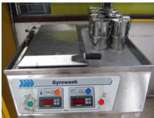
รูปที่ 3.11 เครื่องทดสอบความคงทนสีต่อการซักล้าง (Gyrowash)
