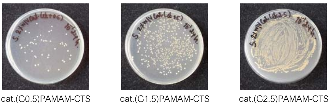
รูปที่ 4.18 แสดงจำนวนโคโลนีของแบคทีเรีย S. aureus ของผ้าที่ตกแต่งด้วยโคโตซาน และ cationic PAMAM-CTS
