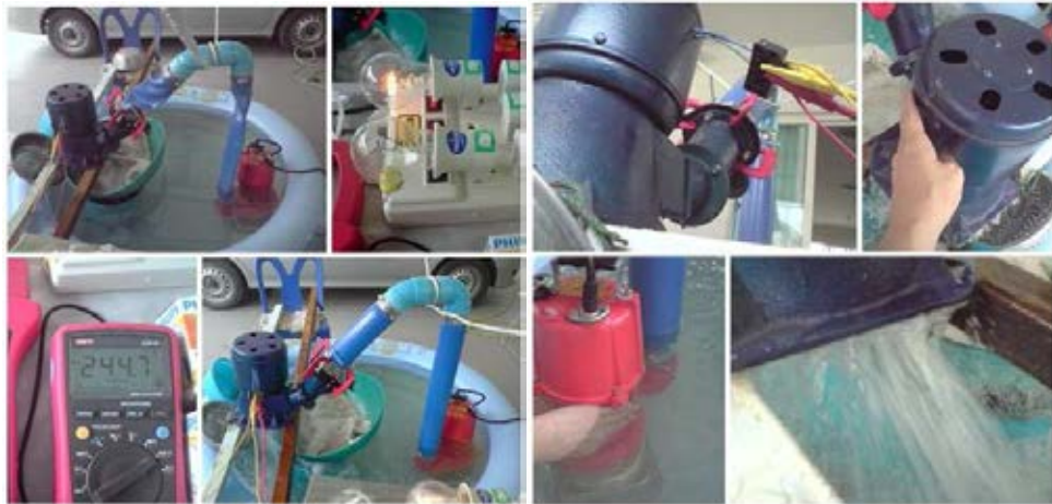
รูปที่ 4.6 การทดลองเพิ่มโหลดไฟเข้าไปในระบบเพื่อหาค่ากำลังไฟฟ้าที่ระบบผลิตได้สูงสุด
