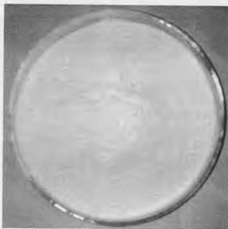
รูปที่ 4.4 กราฟต์พอลิเมทิลเมทาคริเลตซึ่งได้จากปฏิกิริยาไฮโดรลิซิสด้วยกรดไฮโดรคลอริก
