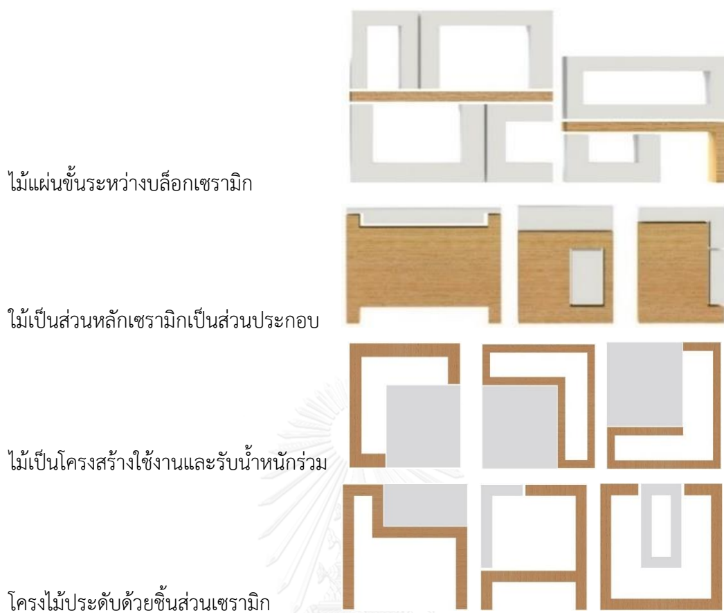
ภาพที่ 156 แนวทางการประกอบชิ้นส่วนเซรามิกกับชิ้นส่วนไม้
