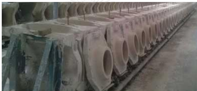
ภาพที่ 95 การผลิตแบบผสมด้วยเทคนิค Battery Casting ที่มา: www.Sanitaryware.org
