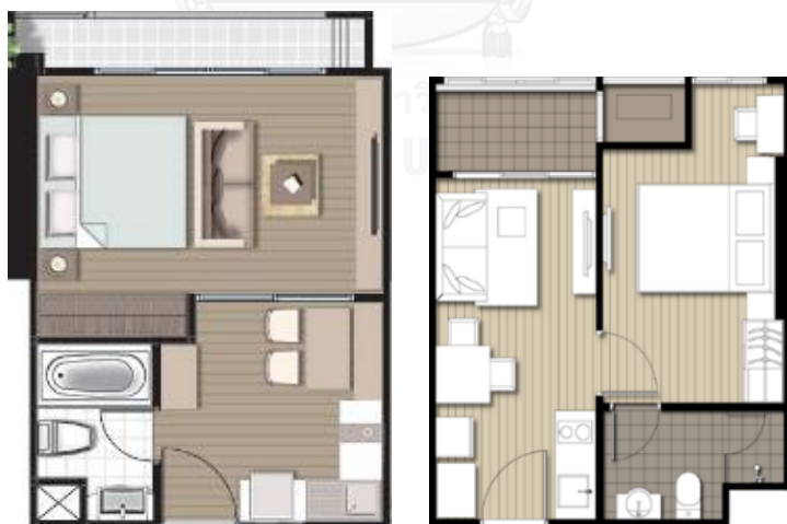
ภาพที่ 11 ตัวอย่างการจัดพื้นที่ใช้งานของอาคารชุดแบบหนึ่งห้องนอนในปัจจุบันขนาด (ซ้าย) 35
