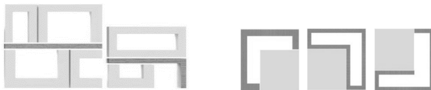
ภาพที่ 160 โครงสร้างเครื่องเรือนเซรามิกจากการศึกษา (ซ้าย) โครงสร้างแบบไม้แผ่นชั้นระหว่างบล็อกเซรามิก, (ขวา) ไม้เป็นโครงสร้างใช้งานและรับน้ำหนักร่วม
