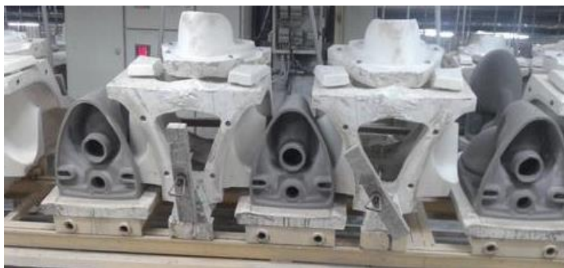
ภาพที่ 94 การผลิตแบบผสมด้วยเทคนิค Battery Casting ที่มา: IndiaMART InterMESH Ltd.
