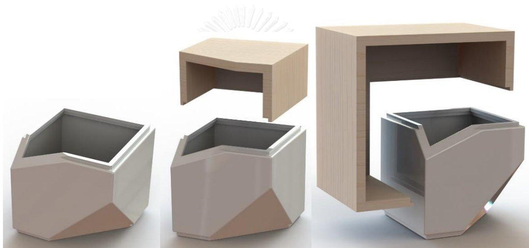
ภาพที่ 183 การประกอบยูนิตพื้นฐานแบบ Interlock Joint
