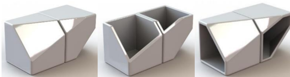
ภาพที่ 190 ยูนิตเซรามิกขึ้นรูปด้วยการหล่อน้ำดิน
