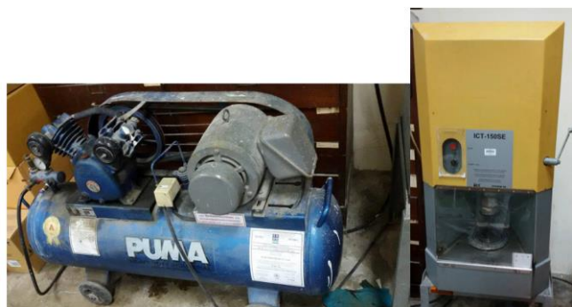
รูปที่ 79 เครื่องบดอัดแบบหมุน(Gyratory Compactor) ในห้องปฏิบัติการผิวทาง
