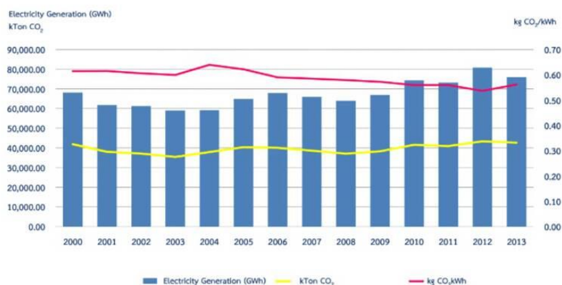
ภาพที่ 3.16 กราฟความสัมพันธ์ระหว่างปริมาณไฟฟ้าที่ผลิตได้กับ ปริมาณคาร์บอนไดออกไซด์ ที่มา : ฝ่ายสิ่งแวดล้อมโครงการการไฟฟ้าฝ่ายผลิตแห่งประเทศไทย 2557
