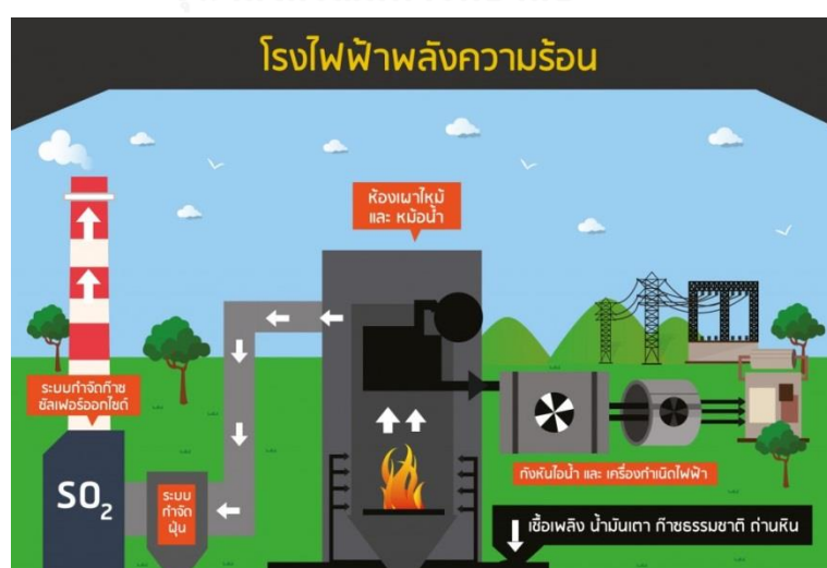
ภาพที่ 3. 6 หลักการทำงานของโรงไฟฟ้าพลังความร้อน
