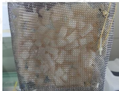
รูปที่ 3.5 ตะแกรงลวดอลูมิเนียมทรงสี่เหลี่ยมผืนผ้าที่บรรจุเซลล์ตรึงบนวัสดุตรึง
