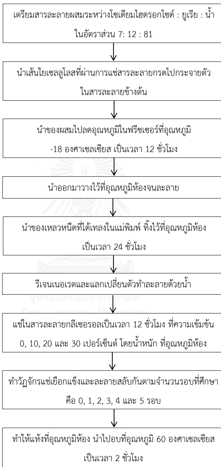
รูปที่ 3.2 ขั้นตอนการเตรียมฟิล์มเซลลูโลสรูพรุน
