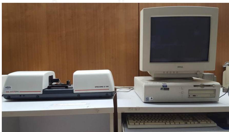
รูปที่ 3.6 เครื่อง Ultraviolet-visible spectroscopy รุ่น SPECORD S 100
