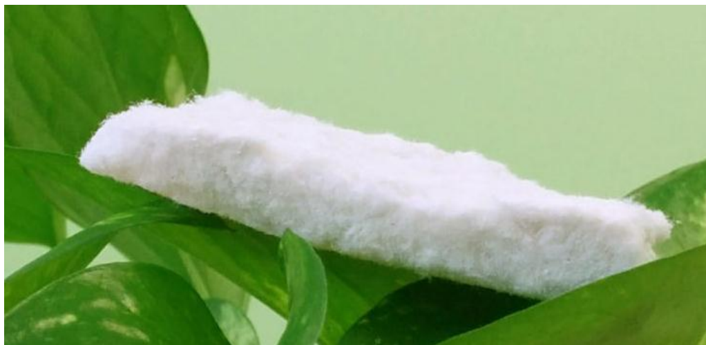
รูปที่ 2.14 เซลลูโลสแอโรเจล (cellulose aerogel) [22]
