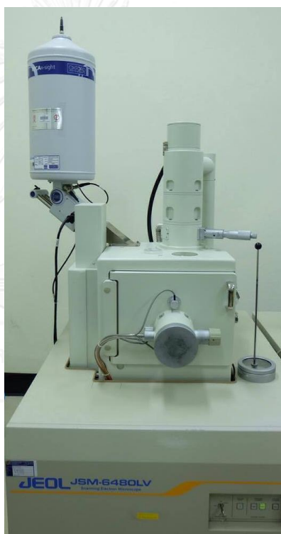
รูปที่ 3.4 กล้องจุลทรรศน์อิเล็กตรอนแบบส่องกราด รุ่น JSM 6400
