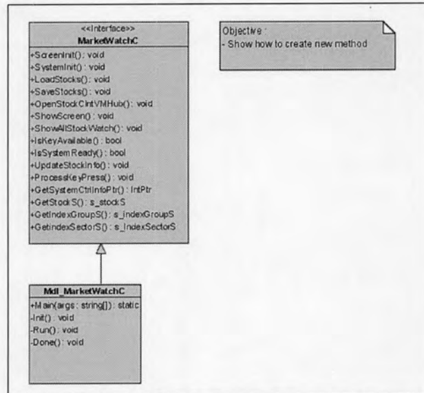
รูปที่ 5.28 แผนภาพคลาส CS_MW.XML
