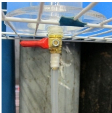
ภาพที่ 3.7 ท่อระบายน้ำ
