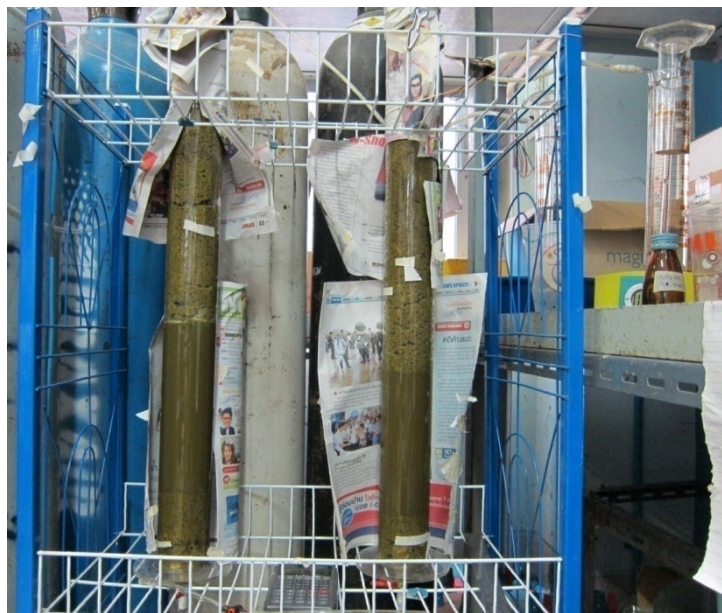
ภาพที่ ข-3.2 หม้อกึ่งนึ่งสีม่วงหมักร่วมกับมูลวัวในถังปฏิกรณ์ของการทดลองที่ 2 ในระบบหมักไร้อากาศแบบขั้นตอนเดียว พร้อมอุปกรณ์เก็บก๊าซชีวภาพ (ชุดถังปฏิกรณ์ด้านขวาคือชุดถังปฏิกรณ์ที่ 1 และชุดถังปฏิกรณ์ด้านซ้ายคือชุดถังปฏิกรณ์ที่ 2)
