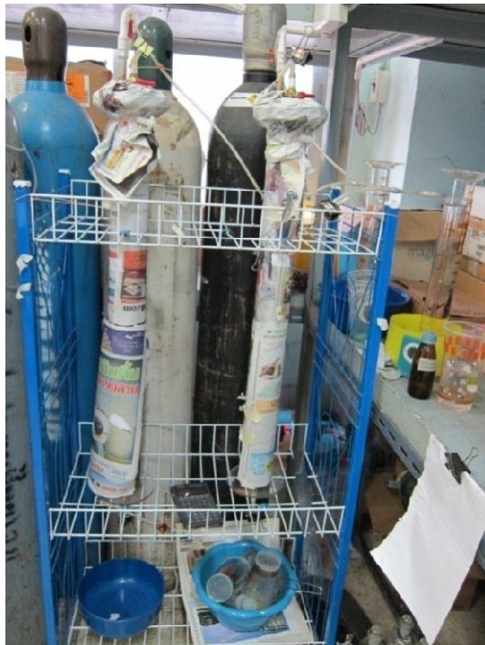
ภาพที่ ข-3.1 ถังปฏิกรณ์ของการทดลองที่ 2 ในที่มีดของระบบหมักไร้อากาศแบบขั้นตอนเดียว พร้อมอุปกรณ์เก็บก๊าซชีวภาพ (ชุดถังปฏิกรณ์ด้านขวาคือชุดถังปฏิกรณ์ที่ 1 และชุดถังปฏิกรณ์ด้านซ้ายคือชุดถังปฏิกรณ์ที่ 2)
