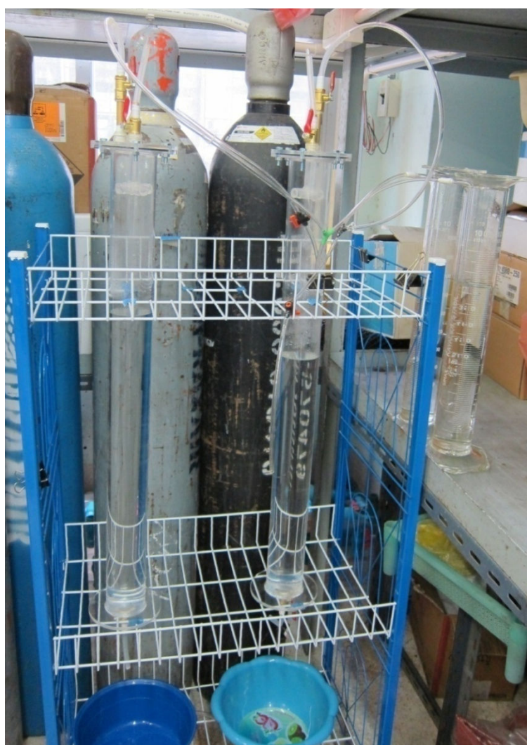
ภาพที่ 3.8 ตั้งอุปกรณ์ที่ใช้ในการทดลองที่ 2 ศึกษาประสิทธิภาพในการผลิตก๊าซชีวภาพ พร้อมอุปกรณ์เก็บก๊าซชีวภาพ
