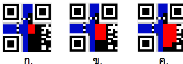
ภาพที่ 3-3 แสดงการเลือกขนาดที่เปลี่ยนบิต ใน Pad Character ของ QR Code
