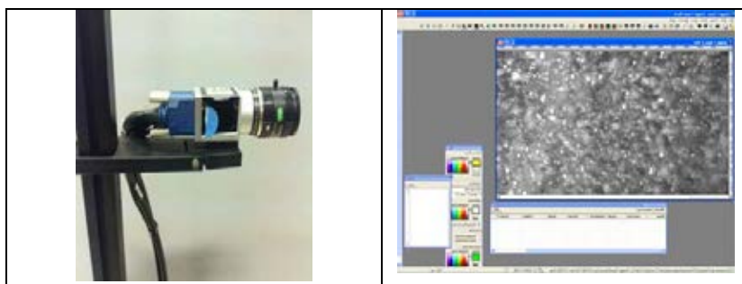
ภาพที่ 3 - 3 กล้องถ่ายภาพความเร็วสูง (ซ้าย) และซอฟต์แวร์วิเคราะห์ภาพ (ขวา)
