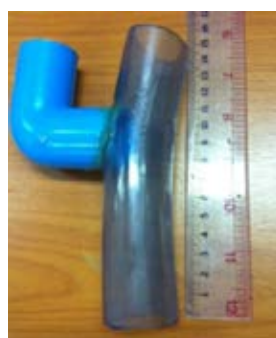
ภาพที่ 3 - 1 ลักษณะของท่อนำอากาศที่ใช้ในงานวิจัย
