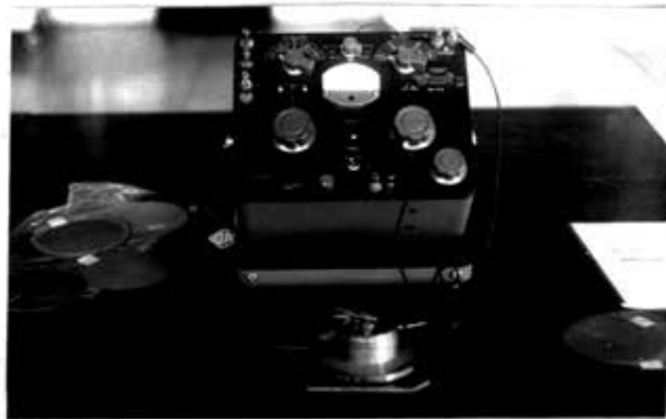
รูปที่ 6.7 การวัดหาค่า \epsilon_r และ \tan \delta
