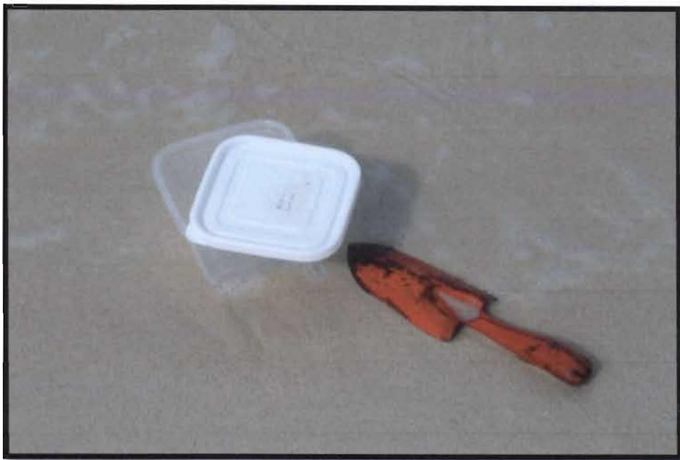
ภาพที่ 2 แสดงอุปกรณ์ภาคสนามที่ใช้ในการเก็บตัวอย่างทราย ได้แก่ กล่องพลาสติกและช้อนพรวน
