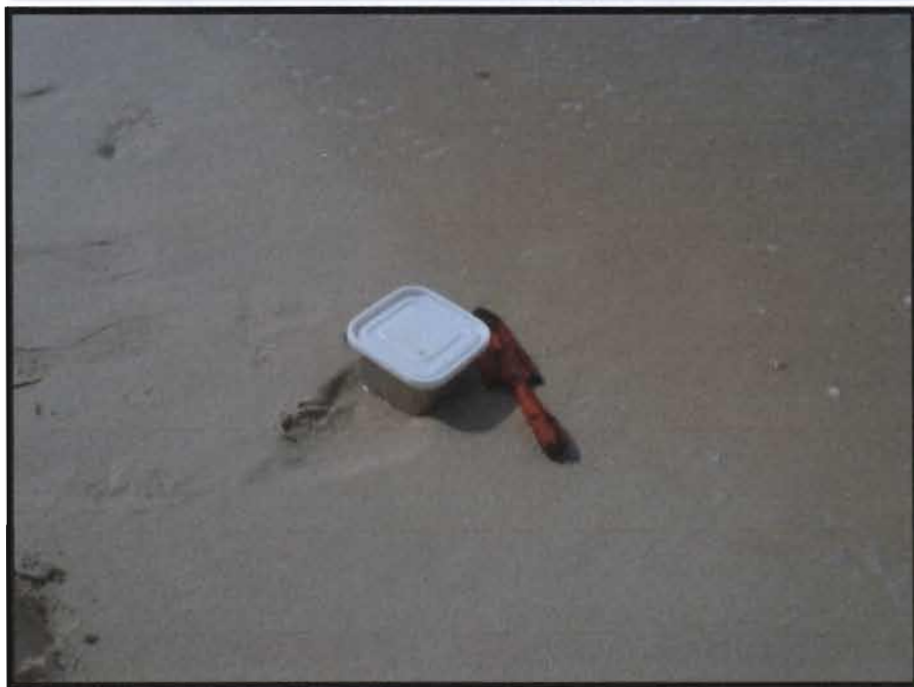
ภาพที่ 7 แสดงขั้นตอนการเก็บตัวอย่างทรายที่บริเวณหาดลูกกลมโดยใช้ช้อนพรวน (ภาพบน) โดยทำการสุ่มเก็บทรายตัวอย่างใส่ลงในกล่องพลาสติกขนาด 750 มิลลิลิตร จำนวน 12 กล่องต่อการออกภาคสนาม 1 ครั้ง ตลอดแนวหาด (ภาพล่าง)
