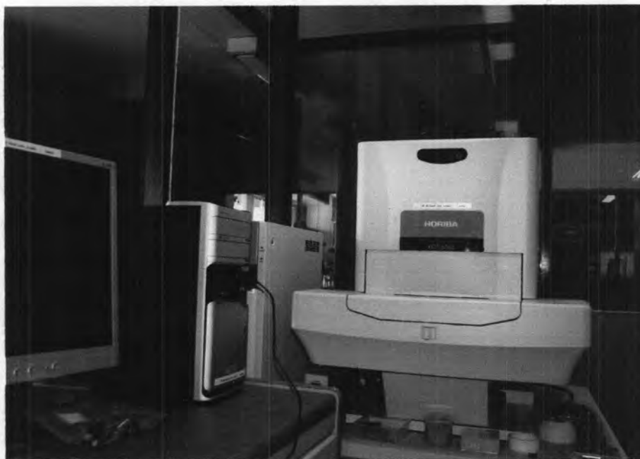
ภาพที่ 1 แสดงเครื่องเอกซเรย์อนาไลติคัลไมโครสโคปโพรบ กำลังขยาย 400 ไมโครเมตร
