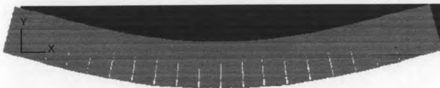
รูปที่ 4.25 รูปร่างและลักษณะทิศทางรอยร้าวของคานที่ได้จากวิเคราะห์ด้วยโปรแกรม
