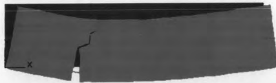
รูปที่ 4.19 รูปร่างและลักษณะทิศทางรอยร้าวของคานที่ได้จากวิเคราะห์ด้วยโปรแกรม
