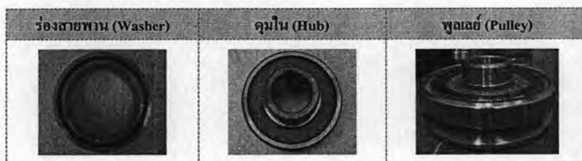
รูปที่ 3.4 ชิ้นส่วนร่องสายพาน, คุมใน และพูลเลย์
