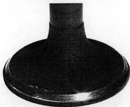
รูปที่ 5-82 แสดงภาพถ่ายวาล์วไอเสียจาก เครื่องยนต์ที่ใช้น้ำมันดีเซล
