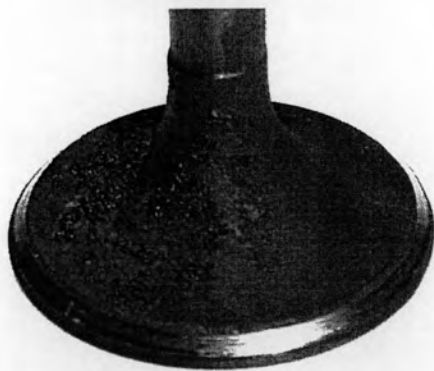
รูปที่ 5-80 แสดงภาพถ่ายวาล์วไอดีจาก เครื่องยนต์ที่ใช้น้ำมันดีเซล
