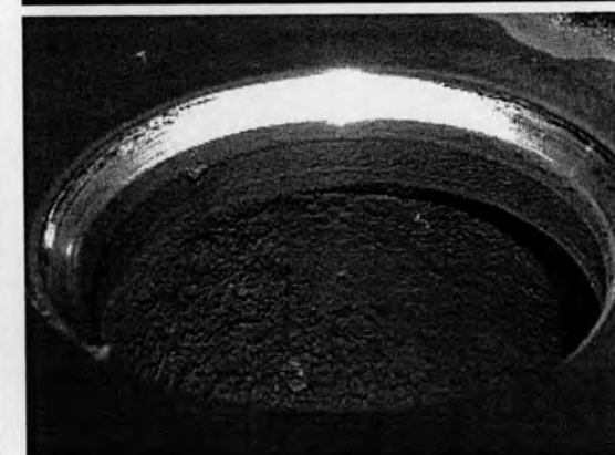
รูปที่ 5-77 แสดงภาพถ่ายบาราล์วไอดีบนฝาสูบ จากเครื่องยนต์ที่ใช้น้ำมันดีเซลทางเลือก
