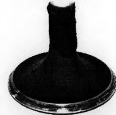
รูปที่ 5-81 แสดงภาพถ่ายวาล์วไอดีจาก เครื่องยนต์ที่ใช้น้ำมันดีเซลทางเลือก
