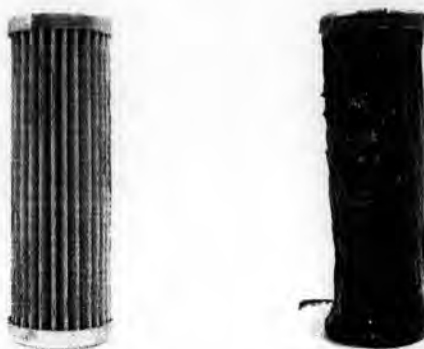
รูปที่ 3-5 แสดงกรองเชื้อเพลิงใหม่(ซ้าย) และกรองเชื้อเพลิงที่อุดตัน(ขวา)
