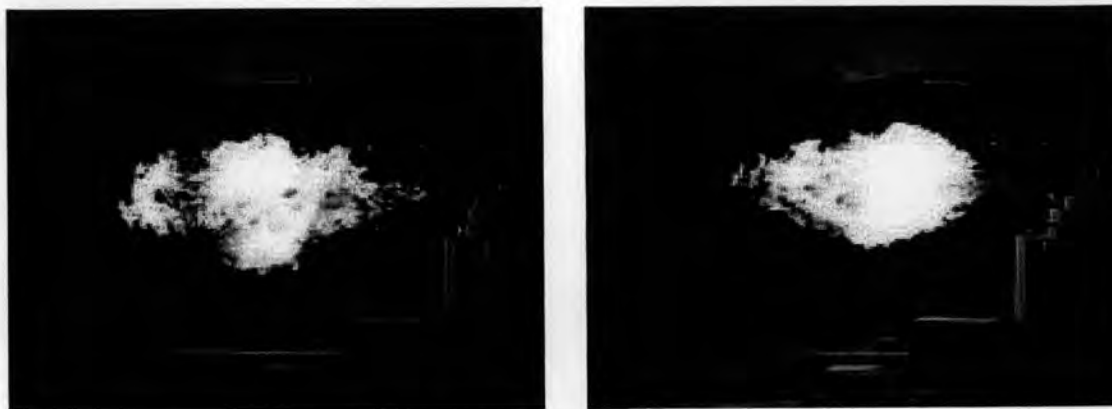
รูปที่ 3-7 แสดงภาพถ่ายลักษณะการเผาไหม้ของสเปร์ยจากหัวฉีดเครื่องยนต์ดีเซล KUBOTA รุ่น ET115 ภาพซ้ายเมื่อใช้น้ำมันดีเซล และ ภาพขวาเมื่อใช้น้ำมันดีเซลทางเลือก
