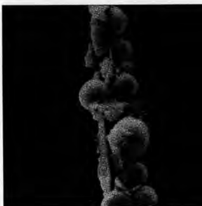
รูปที่ 2-23 แสดงอนุภาคสึกหรอที่เกิดจากการล้าตัวของวัสดุ (Rolling Fatigue Wear Particle)
