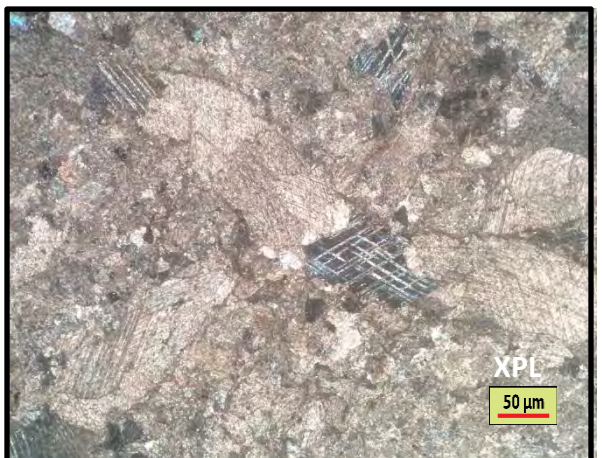
รูปที่ 3.31 หินปูนสีเทาเข้ม(Dark grey limestone) จัดเป็นหินปูนชนิดแวกสโตน(Wackstone)ถึงแพคสโตน(Packstone)ตามการจำแนกของDunham(1962) และพบแร่แคลไซต์ขนาดใหญ่(ภาพ A: PPL และภาพ B: XPL)
