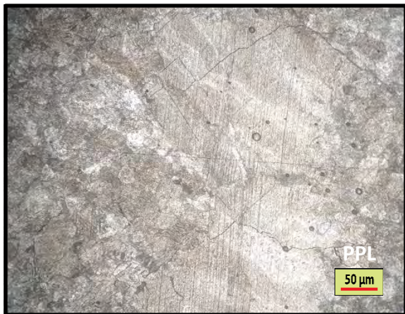
รูปที่ 3.33 ลักษณะของรอยแตกเฉือน(Shear fracture) จากหลักฐานการตัดกันและเคลื่อนตัวของสายแร่แคลไซต์
