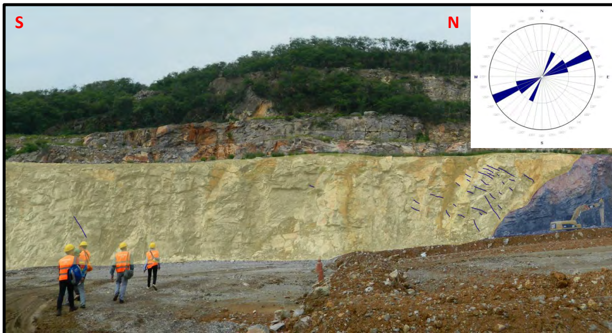
รูปที่ 3.19 ระนาบรอยแตกที่สัมพันธ์กับรอยเลื่อนปกติ (สีน้ำเงิน) ภายในพื้นที่ศึกษา Block 1 และผลของการกำหนดข้อมูลรอยแตกลงบนแผนภาพภูหาลาบ(กลุ่มคนในรูปสูงประมาณ 165-175 เซนติเมตร)
