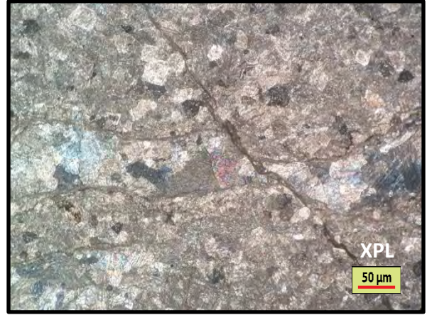
รูปที่ 3.32 หินปูนสีเทาขาวโดโลไมต์เป็นหินปูนประเภทหินปูนBioclastic แบบแฟลตโตจนถึงเกรนสโตนตามการจำแนกของDunham(1962)พบผลึกของแร่โดโลไมต์(ภาพ A: PPL และภาพ B: XPL)
