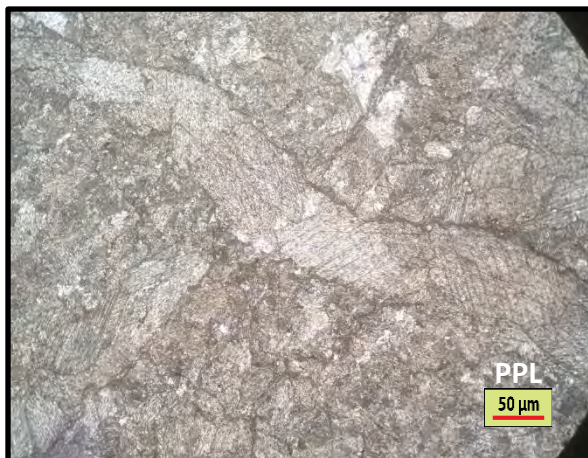
รูปที่ 3.31 หินปูนสีเทาเข้ม(Dark grey limestone) จัดเป็นหินปูนชนิดแวกสโตน(Wackstone)ถึงแพคสโตน(Packstone)ตามการจำแนกของDunham(1962) และพบแร่แคลไซต์ขนาดใหญ่(ภาพ A: PPL และภาพ B: XPL)
