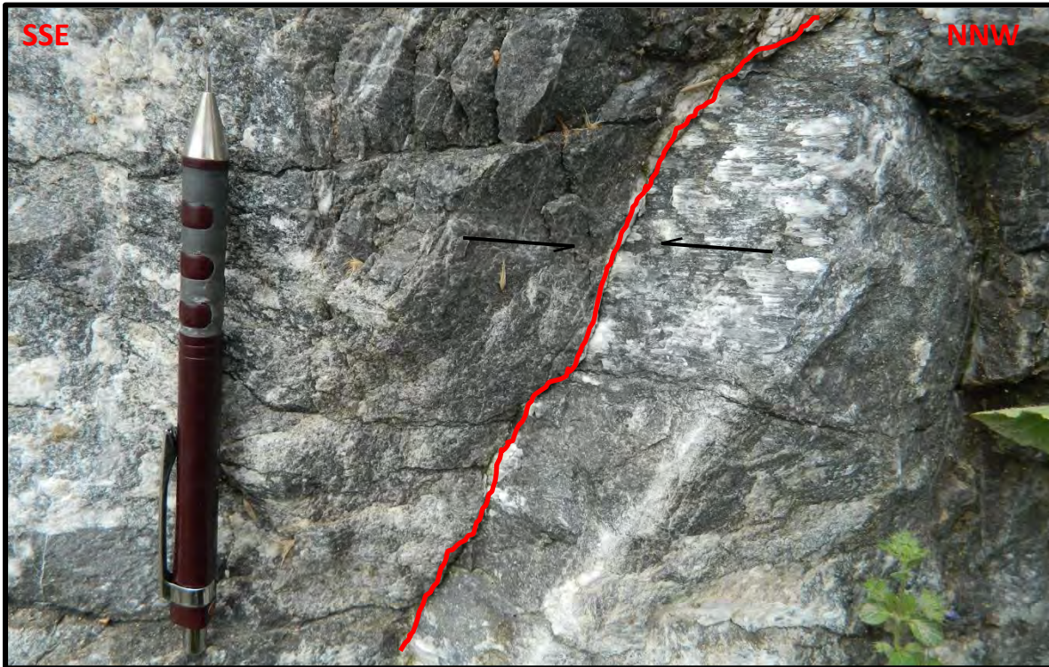
รูปที่ 3.29 ระบายรอยเลื่อนตามแนวระดับและมุมเอียงเท (Oblique-slip fault) ขนานแนวเดียวกับรอยแตกตั้งฉากกับชั้นหิน แสดงระนาบรอยเลื่อน (Slickenside) ที่บ่งบอกถึงการเลื่อนตัวแนวระดับเป็นหลัก (Strike-slip fault) แบบซ้ายเข้า (Sinistral strike-slip fault) (ดินสอยยาว 14 เซนติเมตร)
