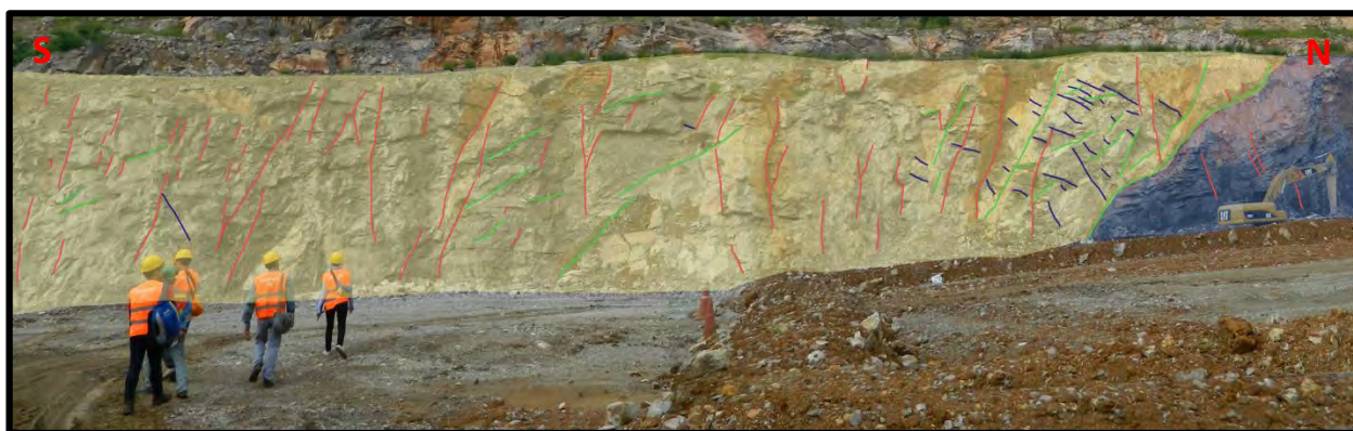
รูปที่ 4.1 ภาพหินโผล่บริเวณพื้นที่ศึกษา Block 1 แสดงระนาบรอยแตกทั้ง 3 ระนาบตัดกัน(กลุ่มคนในภาพสูง ประมาณ 160-170 เซนติเมตร)
