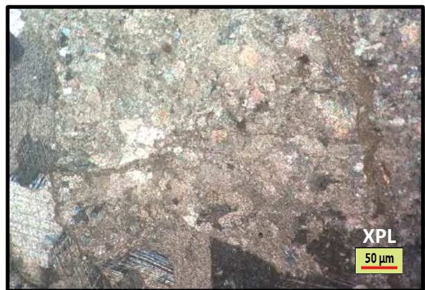
รูปที่ 3.5 หินปูนประเภทหินปูนแวกสโตน(Wackstone)ถึงแพคสโตน(Packstone)(รูป3.4)ตามการจำแนกของ Dunham(1962) ที่แสดงสายแร่แคลไซต์ตัดผ่านเนื้อหินในแนวตั้งฉากกับชั้นหิน(ภาพ A: PPL และภาพ B: XPL)
