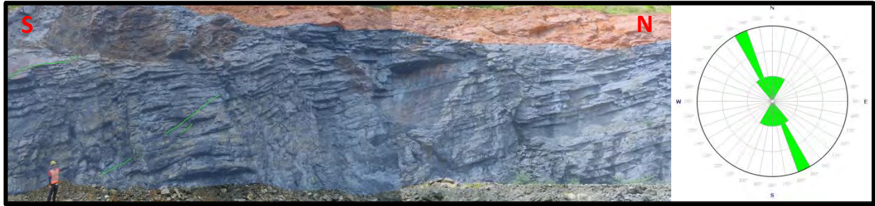
รูปที่ 3.22 ระนาบรอยแตกขนานรอยเลื่อนปกติ (สีเขียว) ภายในพื้นที่ศึกษา Block 2 และผลของการกำหนดข้อมูลรอยแตกลงบนแผนภาพกุหลาบ(คนในรูปสูง 171 เซนติเมตร)
