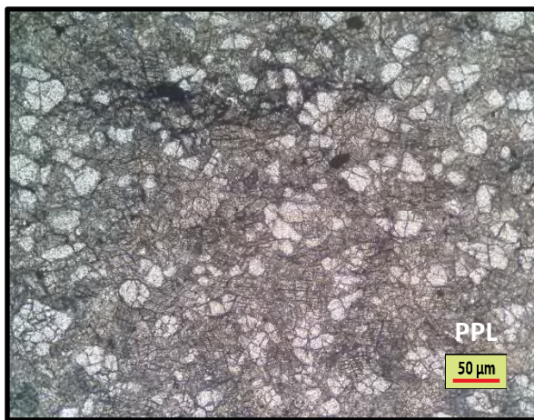
รูปที่ 3.30 หินทรายแป้งเนื้อปูนสีเทาดำ(Dark grey calcareous siltstone) พบกรวดของแร่ควอตซ์และมีตัวเชื่อมประสานเนื้อปูน(ภาพ A: PPL และภาพ B: XPL)
