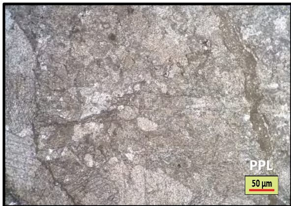
รูปที่ 3.5 หินปูนประเภทหินปูนแวกสโตน(Wackstone)ถึงแพคสโตน(Packstone)(รูป3.4)ตามการจำแนกของ Dunham(1962) ที่แสดงสายแร่แคลไซต์ตัดผ่านเนื้อหินในแนวตั้งฉากกับชั้นหิน(ภาพ A: PPL และภาพ B: XPL)
