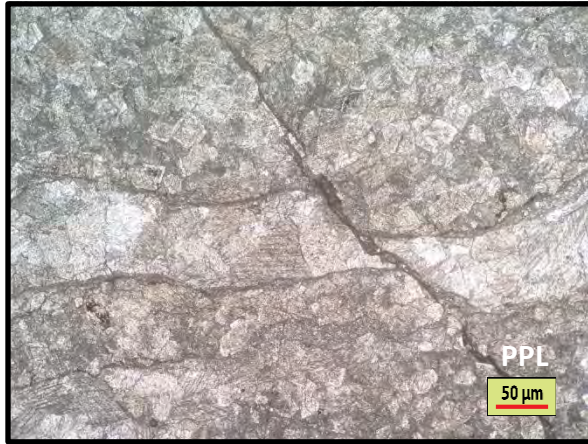
รูปที่ 3.32 หินปูนสีเทาขาวโดโลไมต์เป็นหินปูนประเภทหินปูนBioclastic แบบแฟลตโตจนถึงเกรนสโตนตามการจำแนกของDunham(1962)พบผลึกของแร่โดโลไมต์(ภาพ A: PPL และภาพ B: XPL)
