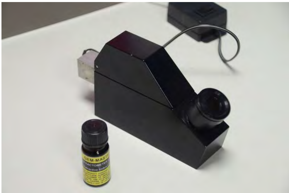
รูปที่ 3.2 Refractometer จากสถาบันวิจัยและพัฒนาอัญมณีและเครื่องประดับแห่งชาติ (องค์การมหาชน)
