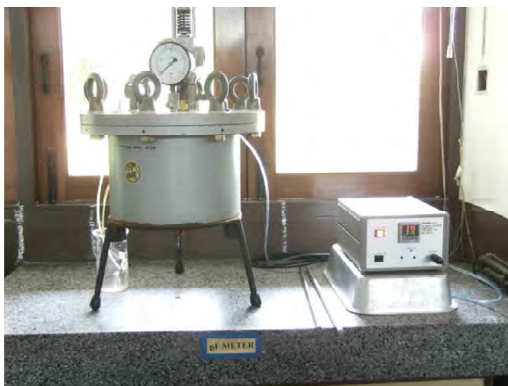
รูปที่ 2.9 เครื่อง Pressure chamber และหน้าปัดที่ใช้ปรับความดันของเครื่อง
