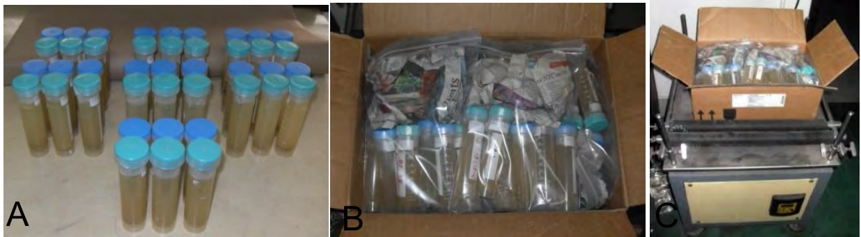
รูปที่ 2.10 A) แสดงตัวอย่างดินที่ผสมกับสารละลายโซเดียมอาร์ซีเนทที่มีความเข้มข้นต่างๆในขวดบรรจุ B) การบรรจุตัวอย่างลงในกล่องก่อนเข้าเครื่องเขย่า C) การนำกล่องใส่ตัวอย่างเข้าเครื่องเขย่า
