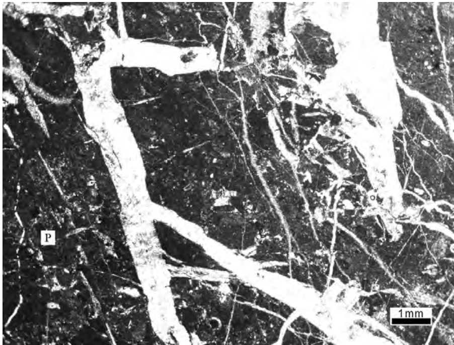
รูป 20 ลักษณะภายใต้กล้องจุลทรรศน์ของตัวอย่าง P-11 แสดงลักษณะของส่วนที่เป็น wackestone มีเมทริกซ์แทรกอยู่ค่อนข้างมาก ตะกอน peloid ที่พบมีขนาดเล็กประมาณ 0.1 มิลลิเมตร และพบสายแร่แคลไซต์แทรกอยู่เป็นจำนวนมาก
