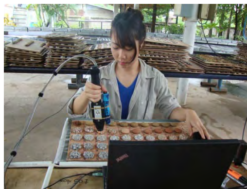
รูปที่ 2.1 การเก็บตัวอย่างจาก core samples (ภาพถ่าย) และการเก็บตัวอย่างจาก rock chips (ภาพขาว)
