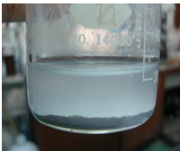
รูปที่ 2.8 วิธีวิเคราะห์แบบ oriented จะได้ส่วนที่เป็นแร่ดินและส่วนที่ไม่ใช่แร่ดินแยกชั้นกัน (ภาพซ้าย) ส่วนที่เป็นแร่ดินจะแยกใส่ plate นำไปวิเคราะห์ต่อ (ภาพขวา)
