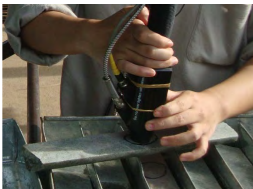
รูปที่ 2.1 การเก็บตัวอย่างจาก core samples (ภาพถ่าย) และการเก็บตัวอย่างจาก rock chips (ภาพขาว)
