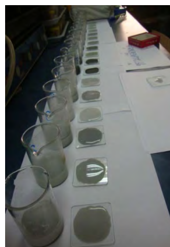
รูปที่ 2.8 วิธีวิเคราะห์แบบ oriented จะได้ส่วนที่เป็นแร่ดินและส่วนที่ไม่ใช่แร่ดินแยกชั้นกัน (ภาพซ้าย) ส่วนที่เป็นแร่ดินจะแยกใส่ plate นำไปวิเคราะห์ต่อ (ภาพขวา)
