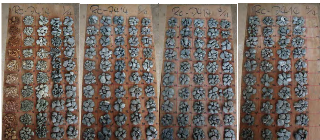
รูปที่ 3.1.1 Rock chip จากหลุมเจาะ 07414RD ใช้ในการศึกษาลักษณะทางกายภาพ
