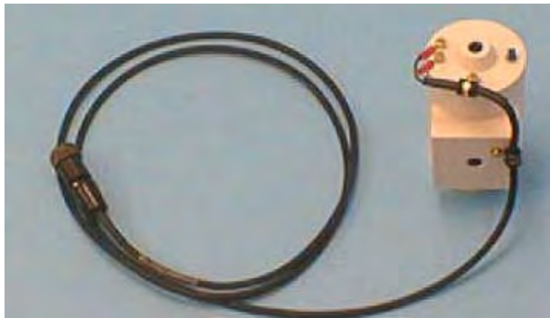
รูปที่ 3.2 ตัวรับค่าสนามแม่เหล็กตัวบนที่ทำการติดตั้งสายเคเบิลเสร็จเรียบร้อยแล้ว
