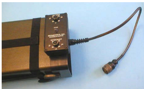
รูปที่ 3.5 การติดตั้งตัวเชื่อมต่อสายเคเบิลเข้ากับเครื่อง Magnetometer
