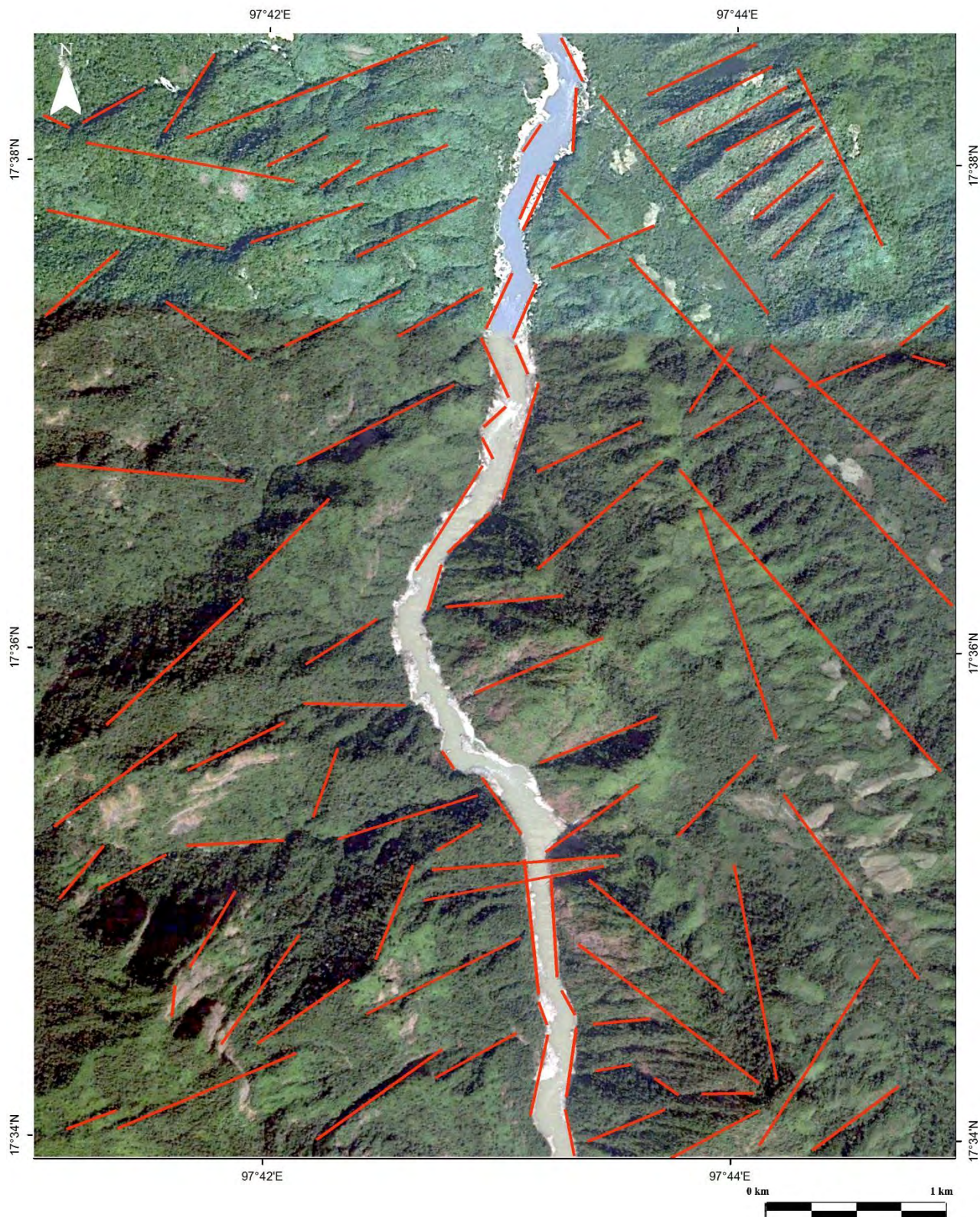
รูปที่ 3.9 แผนที่แสดงแนวเส้นโครงสร้าง (Lineament) ทั้งหมดที่ได้จากการแปลจากภาพถ่ายจากดาวเทียม IKONOS บริเวณหมายเลข 4 จากรูปที่ 3.1
