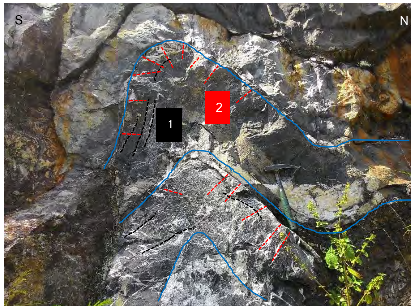
รูปที่ 4.8 การตัดกันของรอยแตกในวิวัฒนาการโครงสร้างลำดับที่ 2 การตัดกันของรอยแตกในช่วงนี้ ตัดกับรอยแตกที่เกิดขึ้นในลำดับก่อนหน้านี้นี้ คือรอยแตกบริเวณเขตพับการคดโค้ง (Radial fracture) (เส้นสีแดง) ตัดรอยแตกที่ขนานกับชั้นหิน (Bed-parallel fracture) และเกิดการคดโค้งตามชั้นหิน (เส้นสีดำ) บริเวณชั้นหินคดโค้ง
