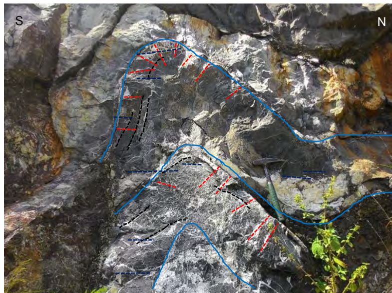
รูปที่ 3.18 รอยแตกที่ขนานกับชั้นหิน (Bed-parallel fracture) ที่มีการคดโค้งที่พบในพื้นที่ศึกษา (เส้นสีดำ) ที่มีการวางตัวขนานกับชั้นหินคดโค้ง (เส้นสีฟ้า), รอยแตกที่เกิดขึ้นบริเวณเขตพับการคดโค้ง (Radial fracture) (เส้นสีแดง), รอยแตกในแนวระดับ (Sub-horizontal fracture) และการตัดกันของรอยแตกที่พบในพื้นที่ศึกษาทั้ง 3 ระบบ
