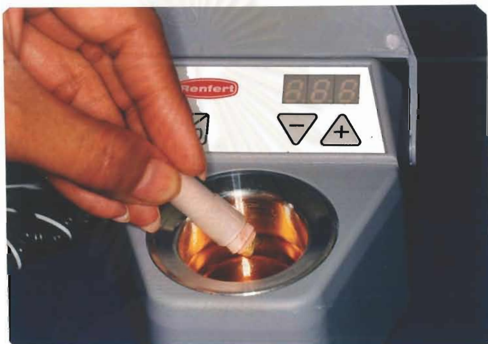
รูปที่ 11 การจุ่มแบบหล่อลงในซีฟิ่งเหลวที่อยู่ในเครื่องควบคุมอุณหภูมิ
