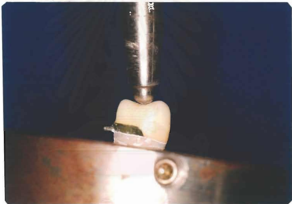
รูปที่ 28 การทดสอบความต้านทานการแตกหักด้วยเครื่องทดสอบสากล
