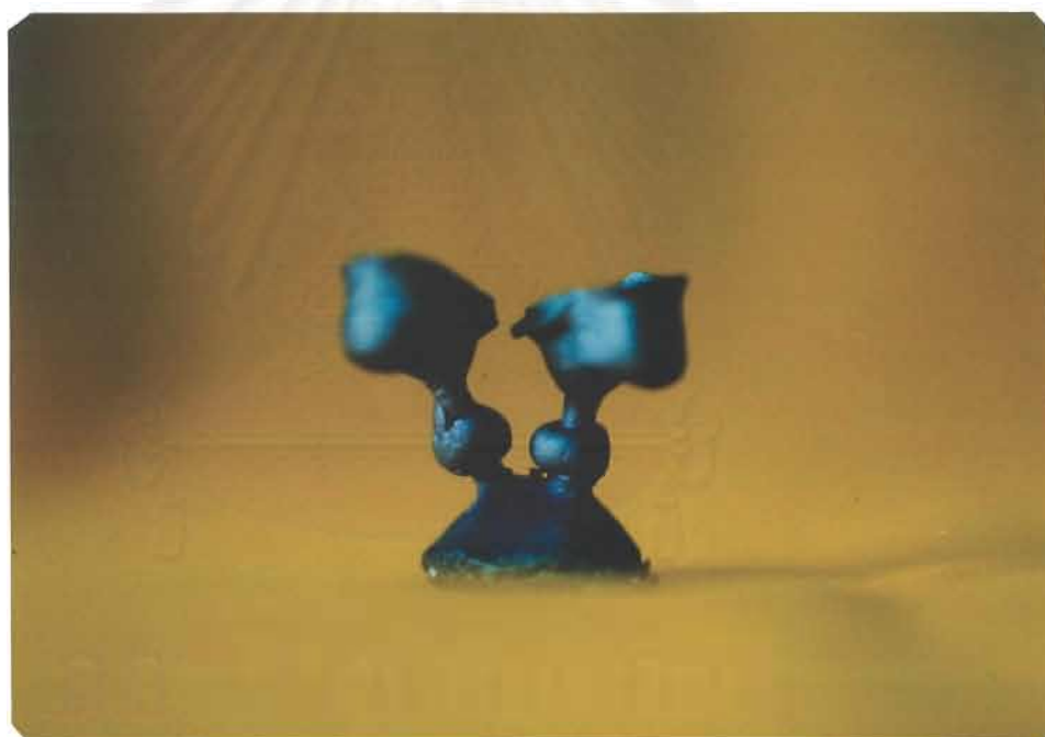
รูปที่ 13 แบบซีฟิ่งที่เหวี่ยงออกมาเป็นโครงโลหะแล้ว
