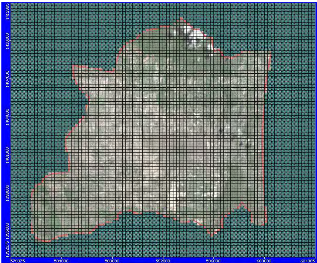
รูปที่ 3.4 การออกแบบกริดในแนวระนาบของแบบจำลอง
