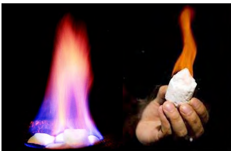
รูปที่ 2.1. รูปแสดงมีเทนไฮเดรต (Methane hydrate) ( www.gns.cri.nz/Our-Science/Energy-Resources/Gas-Hydrates )
